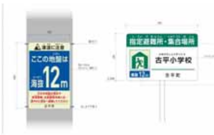
海拔表示板と避難所表示板の設置例
