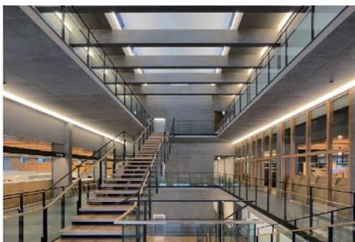
図 吹抜と換気窓で通風と採光確保
